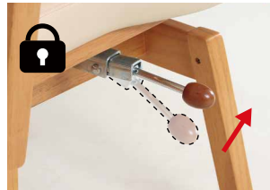
座面を回転させると90°ごとにレバーが自動で上がり、ロックが掛かります。
