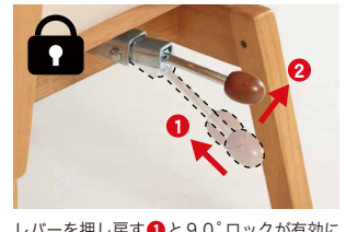
レバーを押し戻すと90°ロックが有効になり、座面を回転させると90°ごとにレバーが自動で上がり、座面が固定されます。
